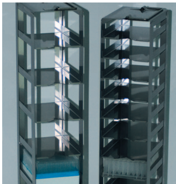
Truhengestelle zur Lagerung von Matrix-Boxen bzw. DeepWell-Platten.
